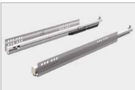
Quadro V6 с демпфером Silent System, направляющие полного выдвижения, 30 кг
